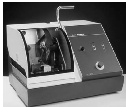
Tronçonneuse de laboratoire Fab. Struers, Type Discotom-5
